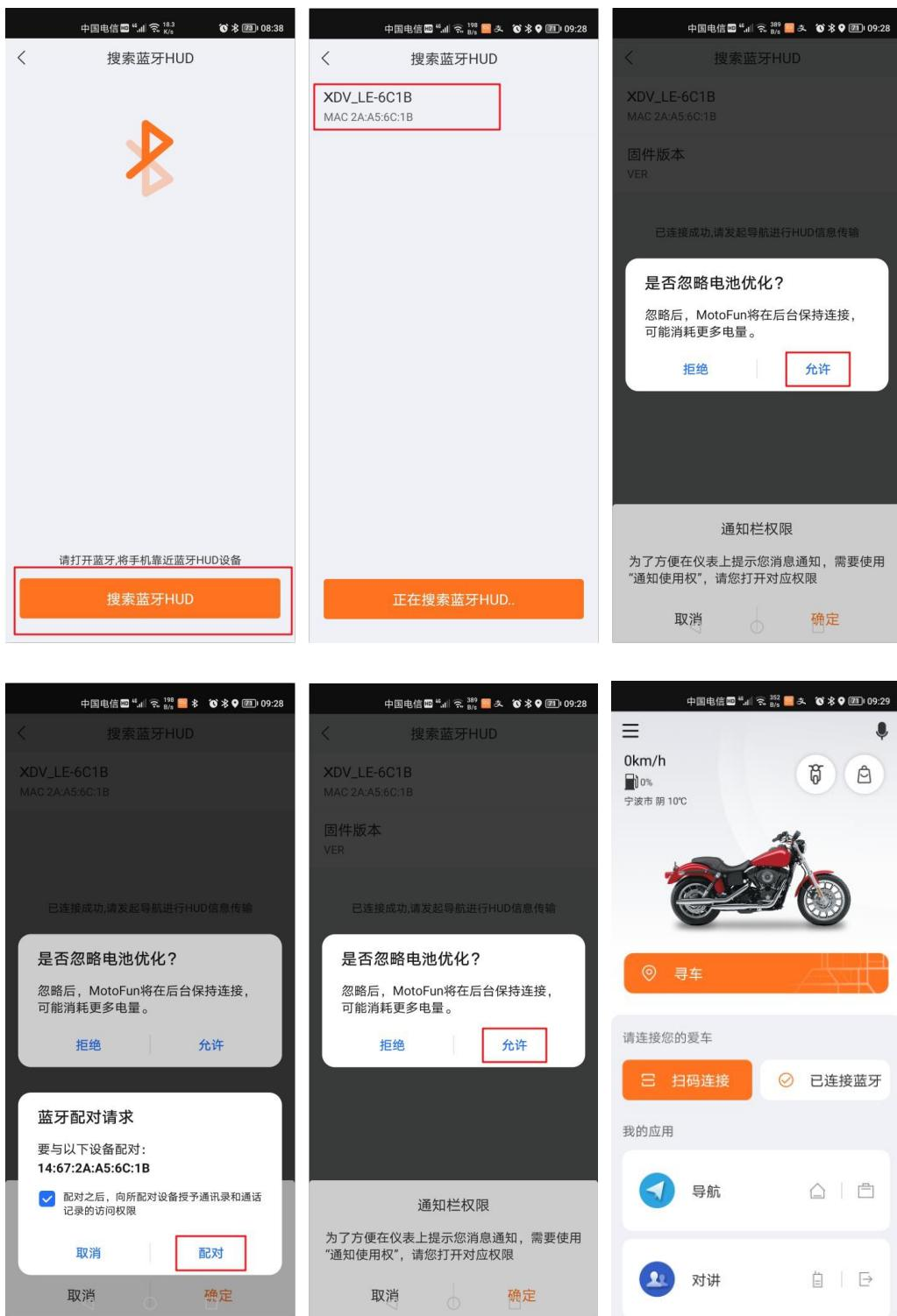
3.2.2 在手机设置里找到蓝牙，可用设备→选择设备名称为3.2.1中“BT:”的后缀（不同仪表设备名称的后四位有差异，演示设备为“XDV-E13A”）→依次点击图中红框选项，连接成功。
